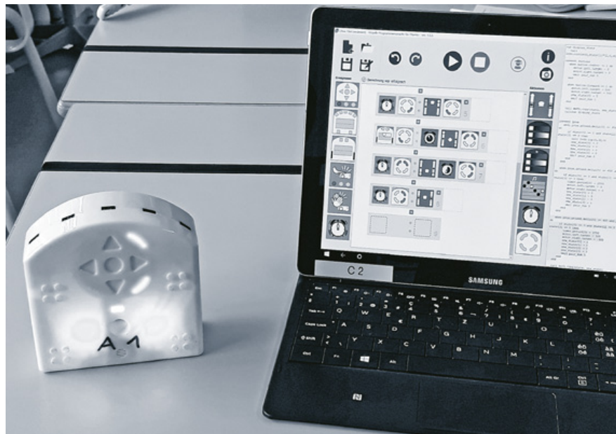
Mit Symbolen wird auf dem Tablet zusammengestellt, was der Roboter anschliessend tun soll.
