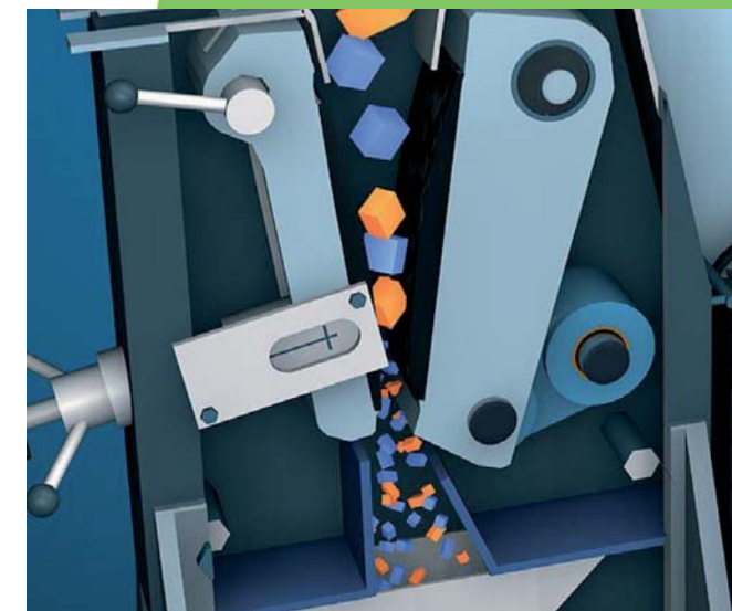
Dieser Querschnitt zeigt, wie das Grobkorn zwischen den Brecher-platten auf unter 150 mm zerkleinert wird.
